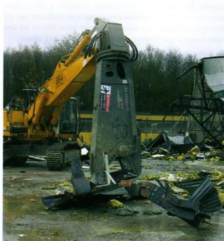
La cisaille MSD 3000 R-SL a une ouverture de 900 mm
